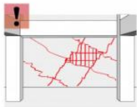
鋼筋外露(剪力牆)
