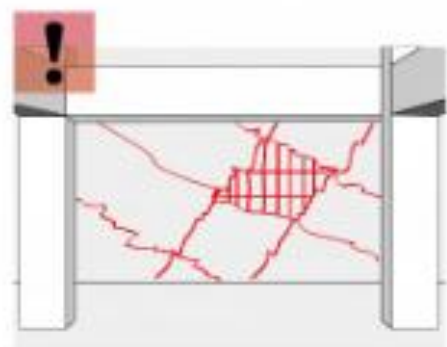
鋼筋外露(剪力牆)
